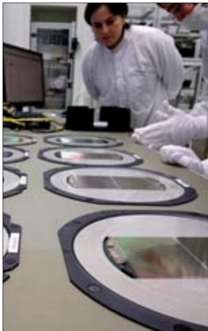
Mehrere Siliziumdetektoren von Infineon im HEPHY Reinraum
