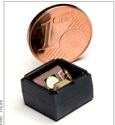
Das Grundelement künftiger Großdisplays: Ein Trixel mit beweglichem Spiegel
